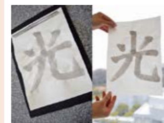
図3 和紙に書かれた墨字は、反射光と透過光の強度を解析することで、筆圧を推定することができる。
